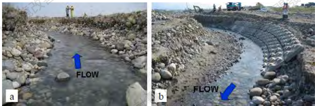
圖 7 日本常願寺自然河岸與混凝土護岸安定性實驗
