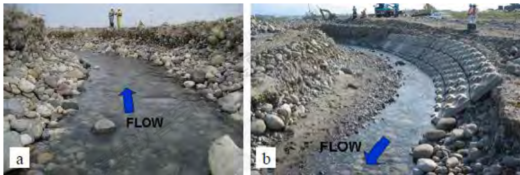
圖 8-1-5 日本常願寺自然河岸與混凝土護岸安定性實驗
