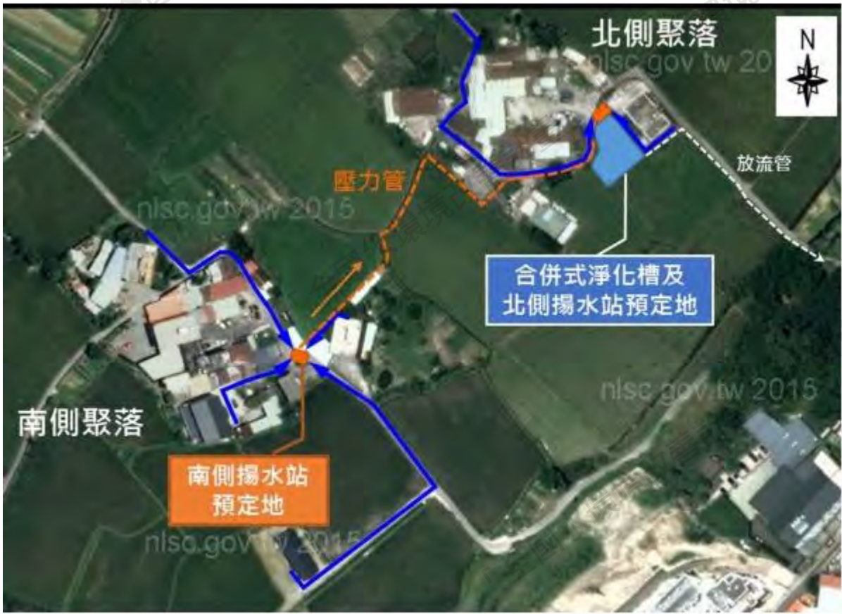
大溪順時埔水質改善工程示意圖，市府將以此打造桃園第一個聚落式小型公共污水下水道系統。(記者李容萍翻攝)
