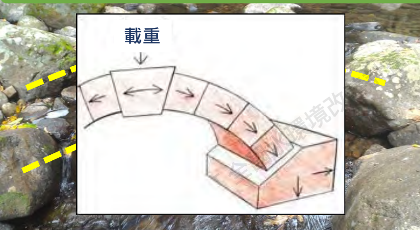
原理1：大洪水時，塊石自然卡合成拱形結構
